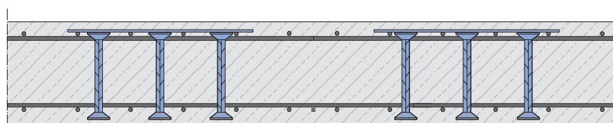
Тонкое плоское перекрытие с арматурой HDB в зоне расположения капителей колонн
