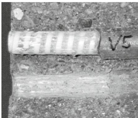
Специальный профиль поверхности арматурного стержня Schöck ComBAR® обеспечивает оптимальное сцепление между бетоном и арматурой.
