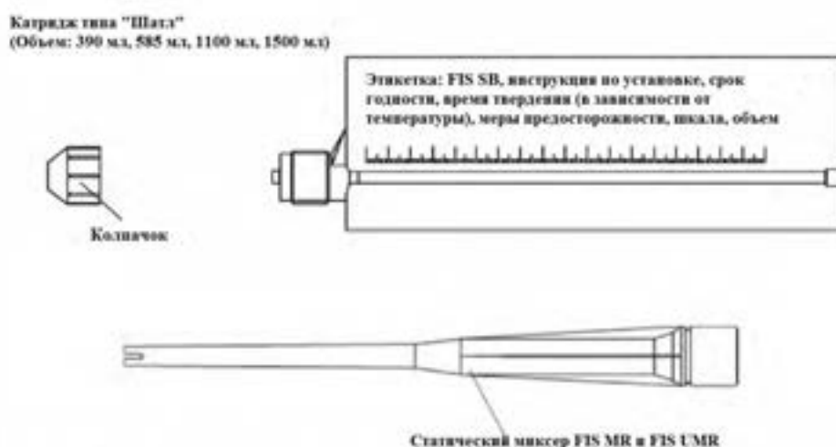
Рисунок 5.3 – Принципиальная схема картриджа с инъекционным составом FIS SB.
