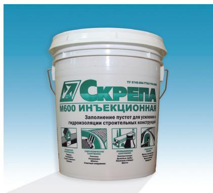
**6.14. «СКРЕПА М600 ИНЪЕКЦИОННАЯ»** – сухая строительная гидроизоляционная инъекционная смесь, предназначенная для заполнения швов, трещин, пустот, полостей размером более 0,4 мм в строительных конструкциях методом инъектирования с целью их уплотнения и усиления, а также для обеспечения водонепроницаемости.
