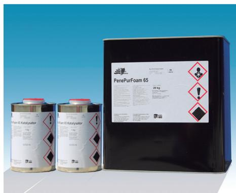
**6.12. «ПЕНЕПУРФОМ 65» – полиуретановая, однокомпонентная, гидроактивная, инъекционная смола низкой вязкости. При контакте с водой вспенивается, заполняя свободное пространство, образует плотную водонепроницаемую жесткую пену с закрытой мелкоячеистой структурой.**
