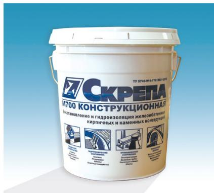
**6.15. «СКРЕПА М700 КОНСТРУКЦИОННАЯ»** – сухая строительная ремонтная объемно-восстановительная конструкционная смесь. Состоит из портландцемента, кварцевого песка определенной granulometрии, комплекса химических добавок и армирующего фиброволокна.
