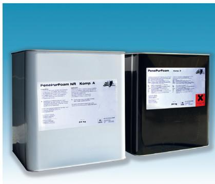
**6.10. «ПЕНЕПУРФОМ Н», «ПЕНЕПУРФОМ НР», «ПЕНЕПУРФОМ Р»** – двухкомпонентные гидроактивные инъекционные низковязкие полиуретановые смолы, которые при взаимодействии с водой способны образовывать жесткую пену с закрытой мелкопористой структурой.
