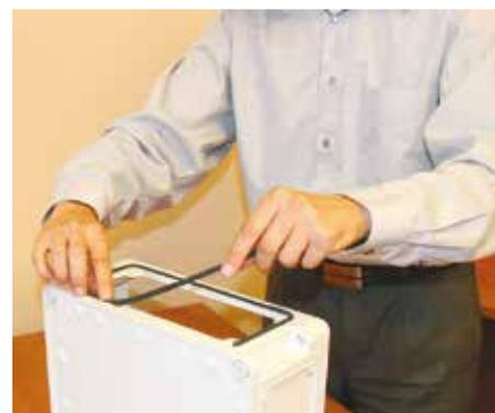
3. Установите уплотнитель на оба объединяемых корпуса
