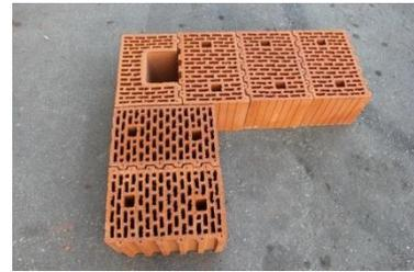
Рисунок 9 – Примеры исполнения крупноформатных поризованных керамических камней (в частности, типа Porotex)
