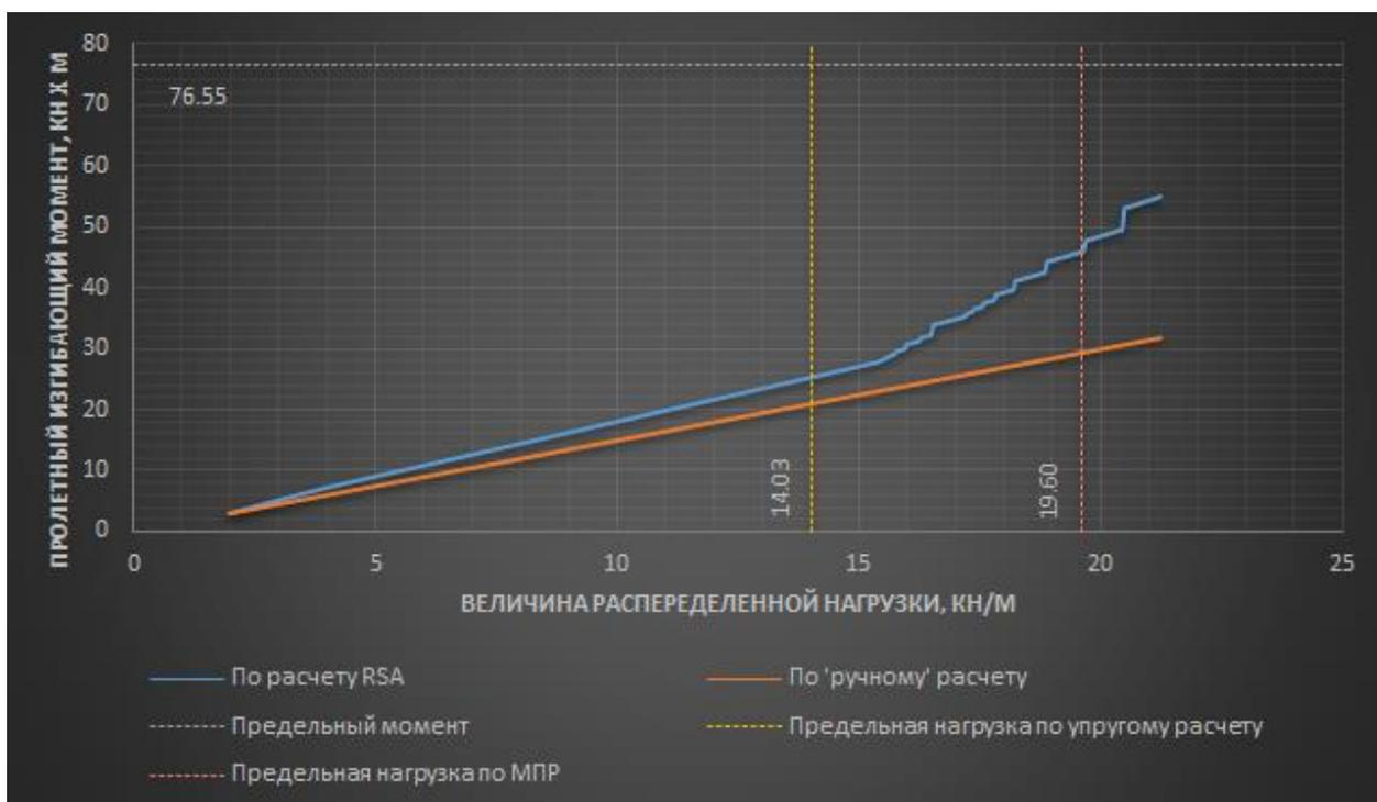
Рисунок 15. График изменения пролетного момента в зависимости от нагрузки на балку
